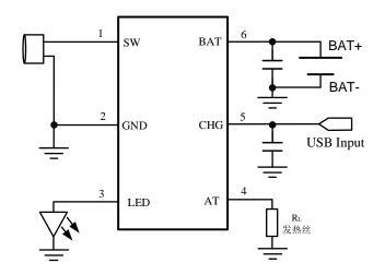
**备注:** 外接电池 BAT 端与外接发热丝 AT 端流过近 **5A** 的电流,在 PCB 设计时需考虑散热,走线尽可能短而宽;同时,增加覆铜面积、过孔等散热措施。
